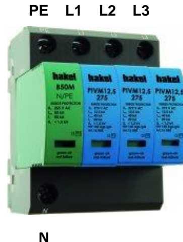
(3 x varistor; 1 x bleskojistka)
