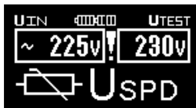
Obr. 3.4b Příklad výsledku měření (zvoleno měření přepětových ochran)
