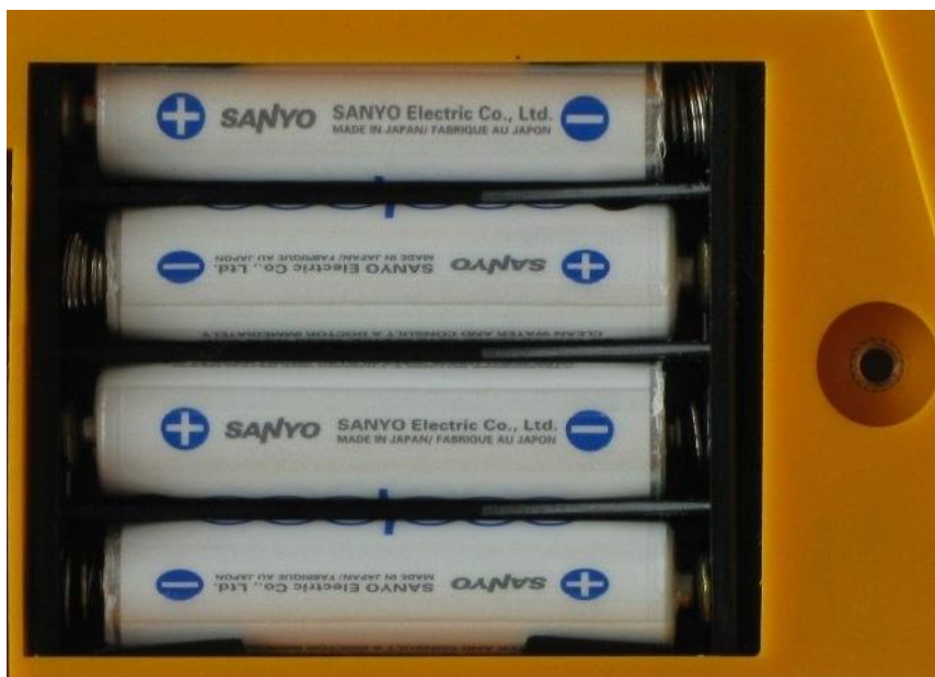
Obr. 4.1 Správná polarita napájecích článků
