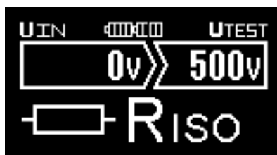
Obr. 3.5 Příklad nastavení pro měření izolačních odporů
