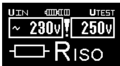
Obr. 3.4a Příklad výsledku měření (zvoleno měření izolačního odporu)
